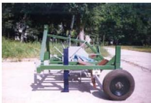
Устройство за противоерозионна обработка на почвата по наклона на склона
